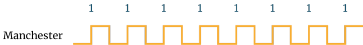
FIGURE V.5.7. – 11111111 en codage Manchester (CC BY)
